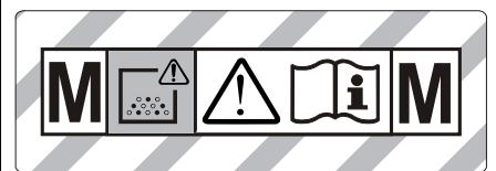
**VARNING:** Denna maskin innehåller hälsovådligt damm. Tömning och skötsel inkl demontering av dammpäsen får endast göras av särskilt utbildad personal med lämplig skyddsklädsel. Koppla ej till innan hela filtersystemet är installerat och volymströmskontrollens funktion kontrollerats.
