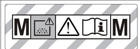
**ADVERTENCIA:** Esta máquina contiene polvos nocivos para la salud. El vaciado de la misma y la retirada de la bolsa de filtro, así como los trabajos de mantenimiento necesarios, sólo podrán ser ejecutados por personal especializado, provisto del equipo protector adecuado. No conectar el aparato antes de instalar completamente el sistema de filtro y verificar el funcionamiento del regulador del caudal volumétrico!
