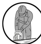
Durante il lavoro indossare indumenti di protezione con antitaglio adatti. Indossare calzature solide dotate di protezione antitaglio e cappuccio di protezione delle dita.
