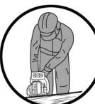
Bei der Arbeit geeignete Schutzkleidung mit Schnittschutzeinlage tra-gen.
